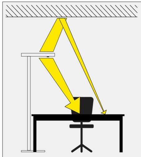
Die von einer Lichtquelle emittierte Lichtstärke nimmt proportional zur zurückgelegten Distanz mit Faktor  $x^2$  ab. Der Reflexionsgrad der Decke beeinflusst, wie viel Licht vom Indirektanteil auf die Arbeitsfläche weitergeleitet wird.
